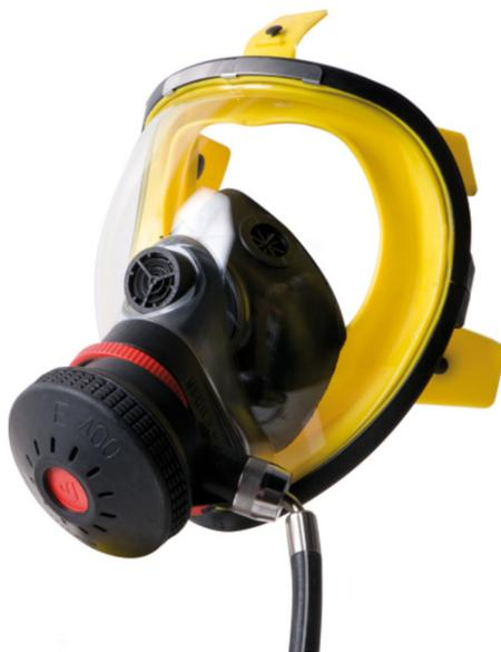
Maschera panoramica di taglia universale, di concezione innovativa, conforme alla *Norma Europea EN 136*. Per l'impiego con filtri antipolvere, antigas e combinati dotati di raccordo filettato EN 148/1 e, nelle versioni SP/A per sovrappressione, con apparecchi di alimentazione d'aria respirabile (con raccordo EN 148/3). Disponibile in **silicone**.
