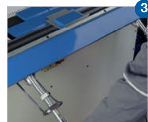
Fase 3: è possibile impostare l'angolo di piegatura corretto usando il dispositivo di controllo angolo. Eseguire la piegatura. L'adeguamento per altri procedimenti di curvatura viene eseguito con pochi movimenti
