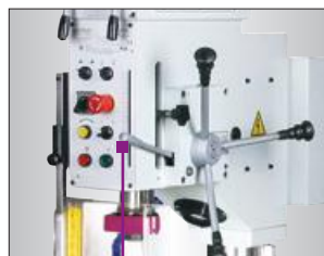
B 40GSP AVANZAMENTO MECCANICO CANNOTTO Regolabile a 2 velocità
