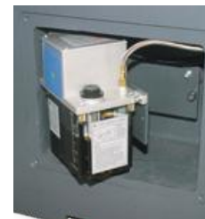
Sistema di lubrificazione centralizzato · Automatico · Apribile per un facile riempimento del serbatoio · Il galleggiante riconosce il livello dell'olio che se scende sotto il minimo attiva un allarme automatico
