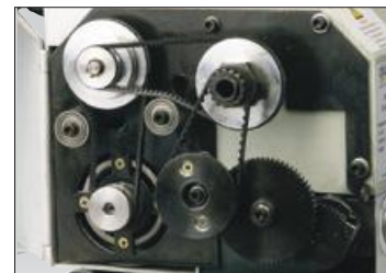
Ampia gamma di passi di filettatura grazie al set ingranaggi di cambio Cambio numero giri semplice e rapido tramite cinghie trapezoidali
