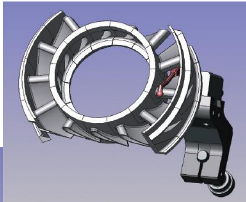
Esempio di girante controllabile sul dispositivo P5N-Jet con relativo tastatore per la scansione del profilo delle palette.
