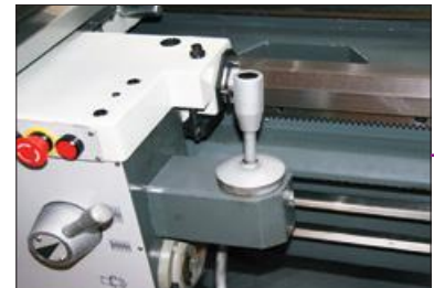
Avanzamento rapido per lavorazioni veloci · Pulsante e leva di selezione per l'attivazione della marcia rapida per direzione trasversale e longitudinale
