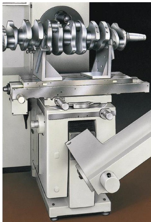
Tipica applicazione del modello Cyclop-1 per il controllo di alberi motore del peso di 200 kg ca.
