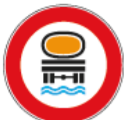
F.R. 262 064 B transito vietato ai veicoli che trasportano prodotti suscettibili di contaminare l'acqua
