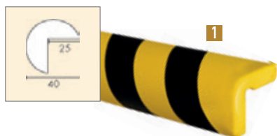
1 PGE425S - paracolpi lunghezza 780 mm x Ø 40 mm, peso 135 gr con biadesivo PGE425SM - come sopra ma magnetico
