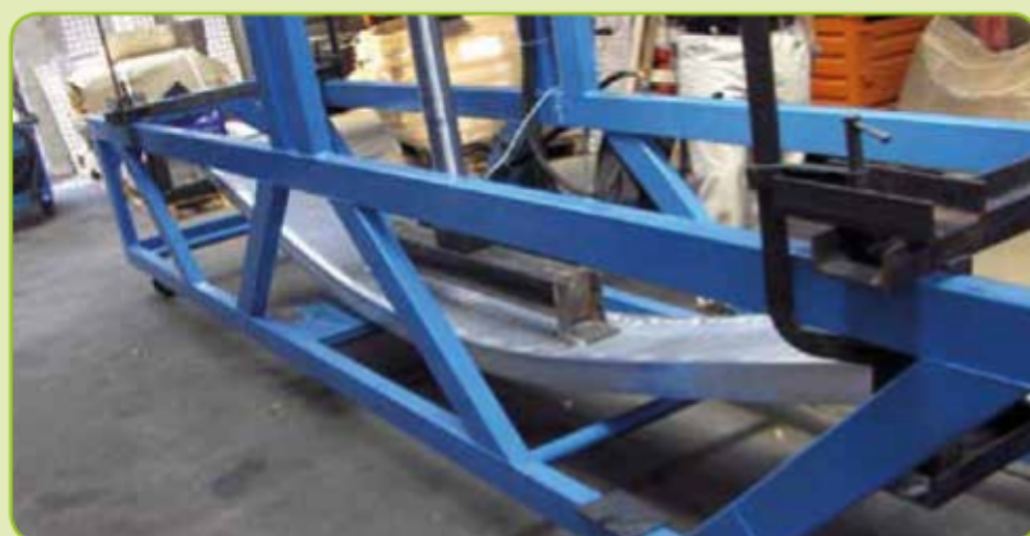
Rampa sottoposta a rottura.
